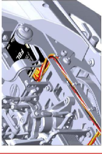
**11** Prüfen Sie die Befestigung des Heckmilenhebels und stellen Sie eine leichtgängige und präzise Funktion sicher.
